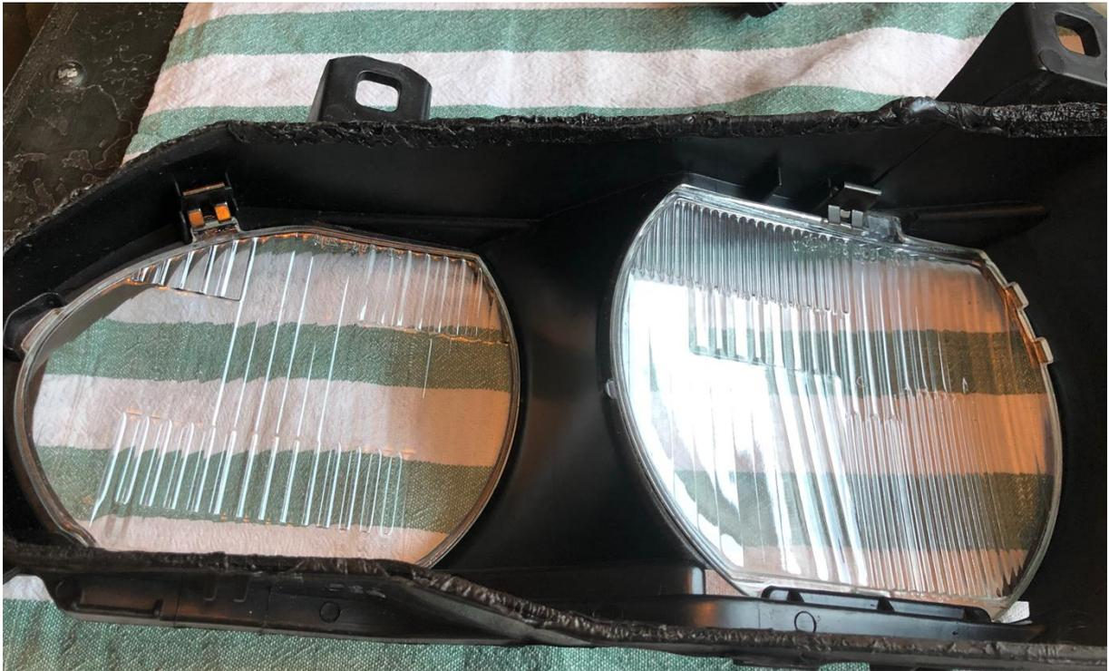
Guckt euch gut an, wie die Streuscheiben eingelegt sind, unten hinter der kleinen Plastikschiene.
