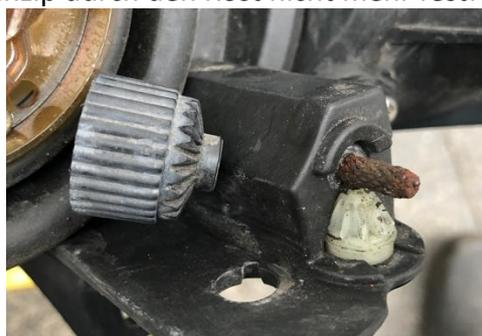
Leider drehten die Einstellräder durch und saßen nicht mehr fest auf der Achse. Eigentlich fielen sie fast von alleine ab. Fehlt das Einstellrad ist die Funktion des Einstellens nicht mehr gegeben und auch der Gegenhalt für den Reflektor fehlt. Durch Erschütterungen wird sich der Reflektor von selbst verstellen. Ich glaube durch die Bilder wird es klar.
