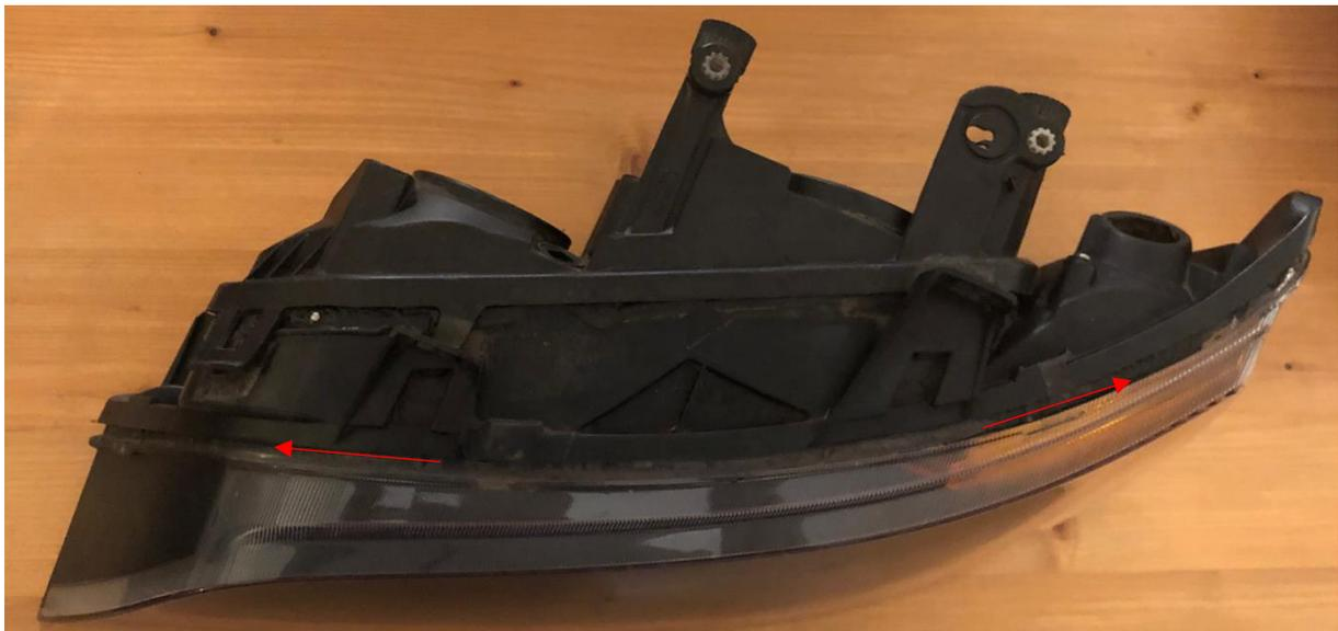
Das Aushebeln auf der unteren Seite wiederholen. Beim Auseinanderziehen aufpassen, der Kleber zieht lange Fäden und kann auf die Gläser und Reflektoren gelangen.
