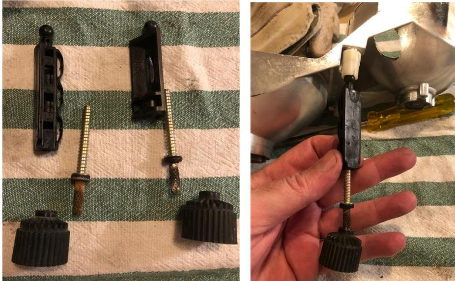
Um das Problem zu lösen, habe ich als erstes den groben Rost entfernt, Rostumwandler Fertan aufgetragen und einen Tag einwirken lassen. Dann habe ich die Achse mit einer Feile bearbeitet. Das Ende ein wenig von zwei gegenüberliegenden Seiten abgeschrägt, damit später der Kleber es nicht mehr nur mit runden Seiten zu tun hat, sondern an den neuen Ecken besser Kontakt hat (ziemlich doof zu beschreiben, vielleicht helfen Bilder...)
