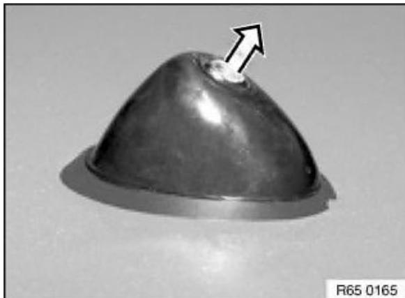
Antennenfuß mit Verstärker von unten gegenhalten und Mutter (1) lösen.
