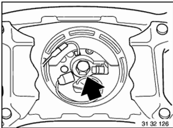
Lenkrad in Geradeausfahrstellung (Markierung am Lenkgetriebe und an Lenkspindel) bringen.
