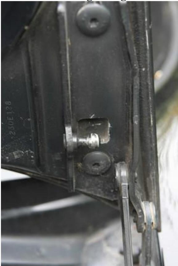
Und jetzt schmierte ich Fett in die Kugelaufnahmen der neuen Dämpfer, die Sicherungsfedern der neuen Dämpfer müssen nicht entfernt werden,
